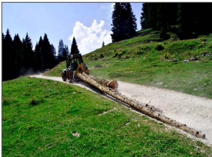
Le débardage est l'action de traîner sur le sol un fût abattu et ébranché. Le tronc est ensuite disposé sur l'aire d'emport ou sur le chantier de débitage. Autrefois réalisé par des chevaux de trait (traction), le débardage sylvicole se réalise aujourd'hui à l'aide machines (abatteuse ou débardeuse), de treuils manuels, sur engins ou portatifs.
