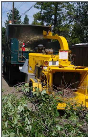
et au transport : chargement volumineux difficile à répartir, dépassement de gabarit de la charge à moins de retailles longues et nombreux trajets de véhicules pour un volume important. Le broyage sur place est donc une solution efficace, qui permet d'éviter les risques, la pollution et les désagréments de l'écobuage, tout en réduisant considérablement les problèmes de transport.
