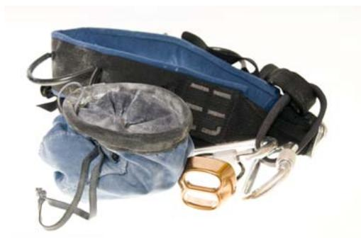
Il existe plusieurs types de harnais, mais le modèle standard possède certaines caractéristiques. C'est d'abord un harnais antichute à trois points équipé d'une ceinture de maintien et sous-fessière, d'un amarrage dorsal antichute et un autre ventral pour l'ascension, le maintien et la descente, ainsi que d'une bouclerie en acier inoxydable avec des points d'emport par mousquetons. Selon la technique de grimpe utilisée, chaque élagueur dispose du matériel le plus adapté à sa pratique.
