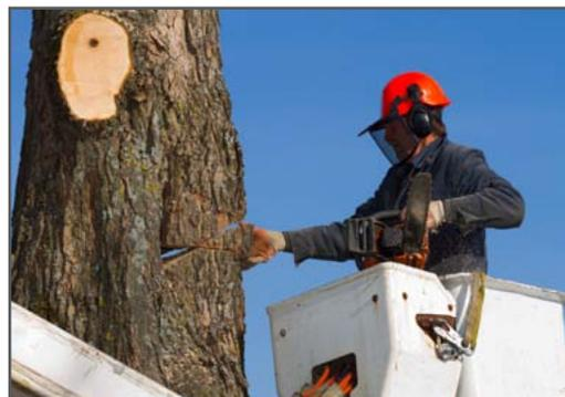
maintien sécuritaire, puisque la nacelle est entourée d'un garde-corps qui peut dispenser d'un harnais, mais aussi un appui stable, puisqu'elle est autostabilisatrice et se positionne en mode « sécurité » en cas de risque de basculement. Il est toutefois indispensable de choisir une nacelle élévatrice pour l'extérieur ; mieux vaut également éviter de faire pénétrer la nacelle dans la couronne de feuillage.
