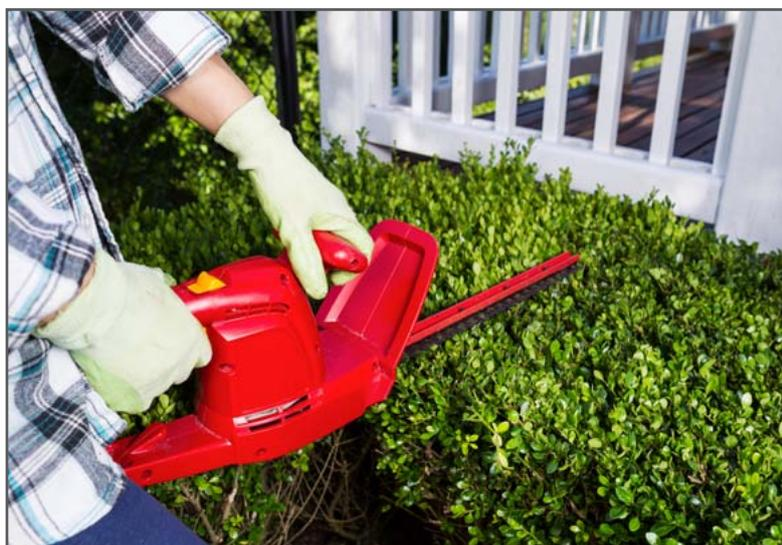
Quel que soit le dispositif de coupe simple ou double, le taille-haie doit se limiter à des branchages n'excédant pas 1 à 1,5 cm de diamètre. Les indications des fabricants sont très souvent optimistes et s'appliquent à des végétaux tendres et bien verts. En règle générale, un taille-haie de moins de
