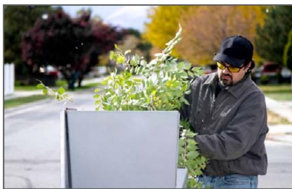
Les broyeurs à végétaux peuvent être alimentés par énergie électrique sur secteur – à réserver aux travaux légers à proximité d'une alimentation électrique –, par énergie thermique grâce à un moteur à quatre temps – à emporter sur le chantier d'élagage –, ou par énergie cinétique sur prise de force d'engin.
